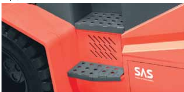
Низкие широкие ступени и опорный поручень облегчают доступ к рабочему месту и сводят усталость оператора к минимуму при работе, требующей многократного входа и выхода из кабины.
