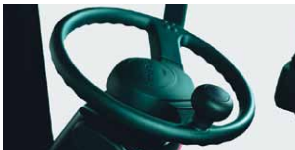
Компактный руль HT Traigo не требует приложения усилий на поворотах. Активный синхронизатор рулевого управления также повышает комфортность работы оператора.
