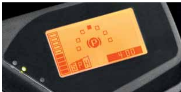
Индикатор направления ясно показывает оператору, в какую сторону повернуты задние колеса
